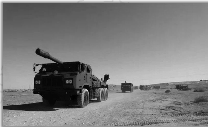
ตัวอย่างรูปภาพ ปืนใหญ่อัตตาจรล้อขนาด 155 มม. (75th Group Army)
