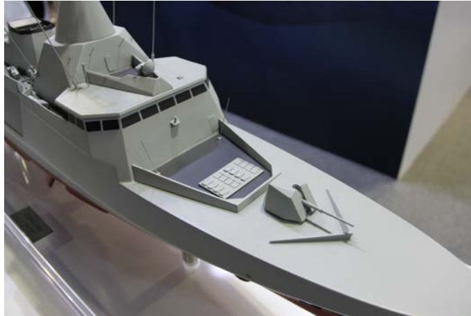
รูปที่ 7 ต้นแบบเรือฟริเกตติดอาวุธนำวิถีแบบ SIGMA
