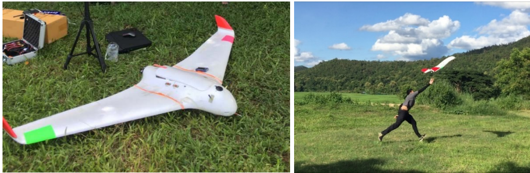
รูปที่ 4 อากาศยานไร้คนขับ Delta Wing ที่ใช้ในการบินถ่ายภาพ
