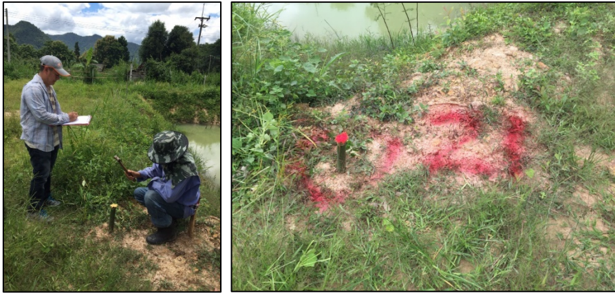
รูปที่ 3 แสดงการสร้างสัญลักษณ์ของตำแหน่งที่ตั้งหมุดควบคุมภาคพื้นดิน
