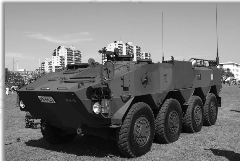
ตัวอย่างรูปภาพ ยานเกราะล้อยาง Type 96 ขับเคลื่อนแบบ 8X8 (Wikipedia)
