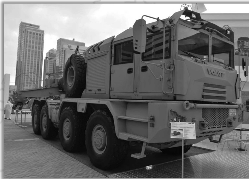
รูปภาพ รถขนถ่ายทางทหาร MZKT-741351 ขับเคลื่อนแบบ 8x8 (IHS Markit)
