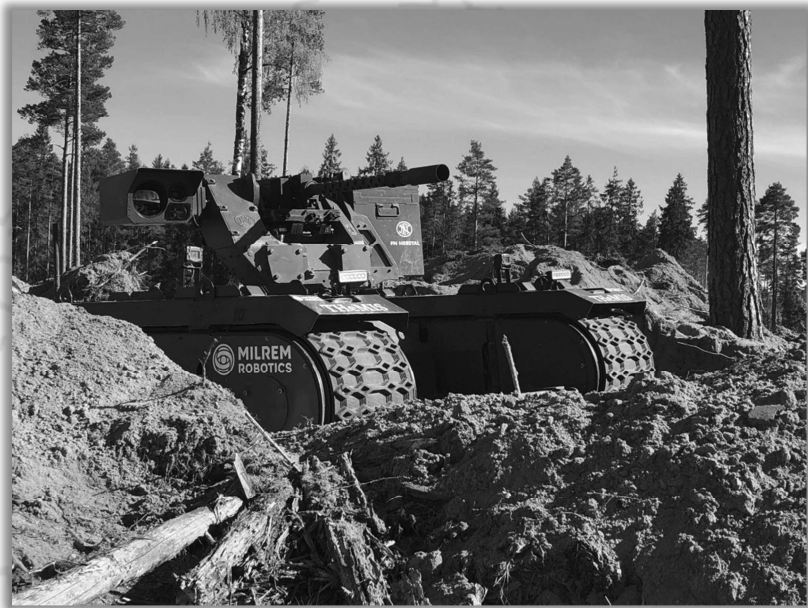
ตัวอย่างรูปภาพ ยานยนต์ไร้คนขับแบบ THeMIS (Milrem Robotics)
