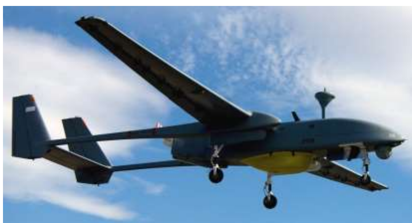
รูปที่ 2 อากาศยานไร้คนขับ Heron 1 MALE UAV (Wikipedia)
