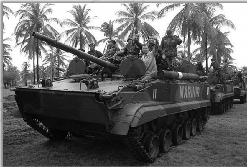
ตัวอย่างรูปภาพ ยานรบทหารราบ รุ่น BMP-3F (ARMY Technology)
