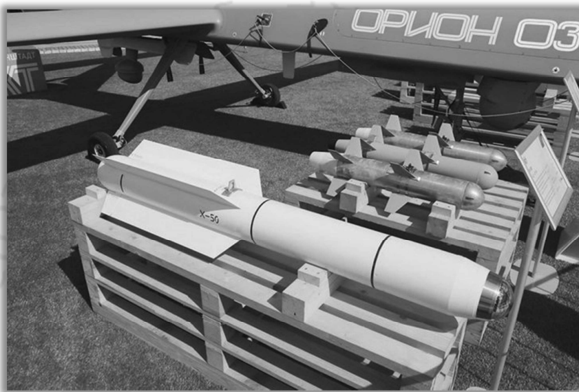
รูปภาพ อาวุธปล่อยนำวิถี Kh-50 และระเบิดนำวิถี KB-20 (Nikolai Novichkov)
