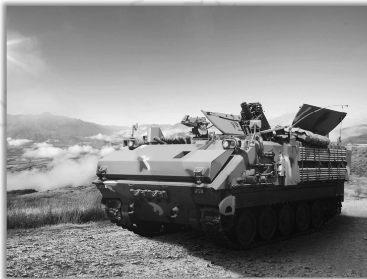
ตัวอย่างรูปภาพ เครื่องยิงลูกระเบิดอัตตาจรขนาด 120 มม. (Hanwha Defense)
