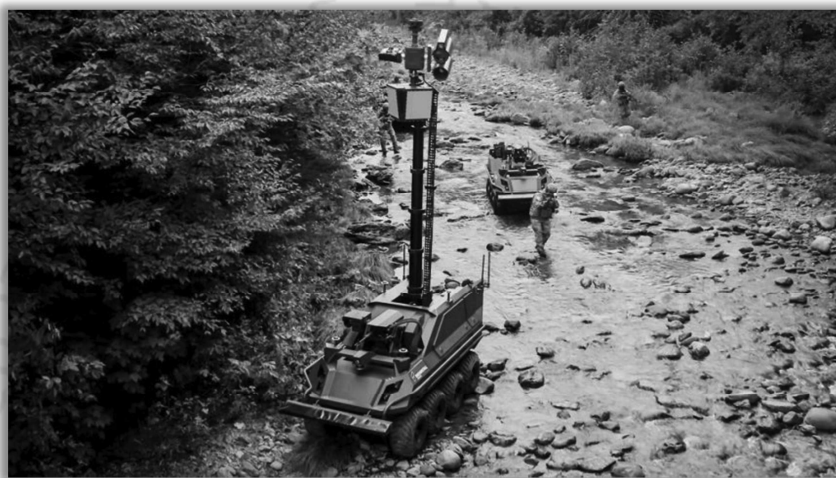
ตัวอย่างรูปภาพ ยานรบภาคพื้นดินไร้คนขับอัตโนมัติ Mission Master (Rheinmetall)
