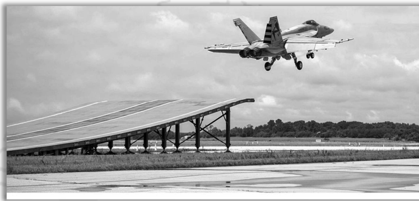
รูปภาพ การทดสอบการบินขึ้นจากทางวิ่ง Sky-Jump ของเครื่องบินขับไล่ F/A-18E/F (US Navy)
