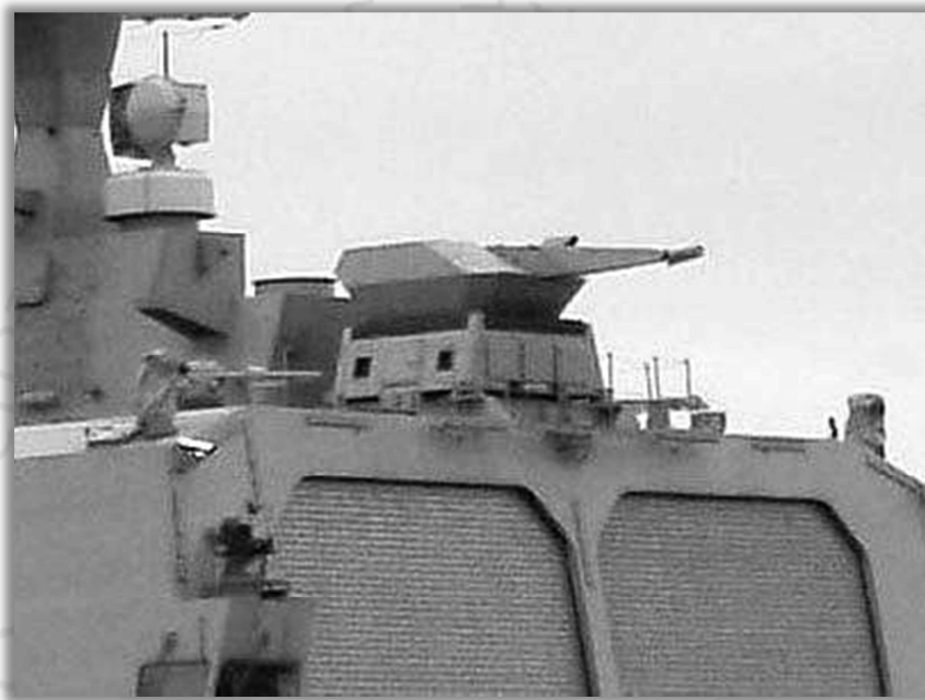
ตัวอย่างรูปภาพ ระบบ CIWS Rheinmetall Oerlikon Millennium Gun (Wikipedia)
