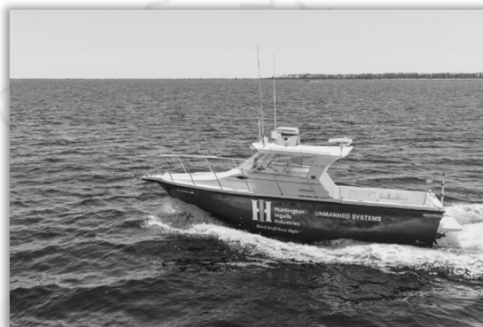
รูปภาพ ยานผิวน้ำไร้คนขับ Proteus 2.0 (ที่มาของภาพ: HII)
