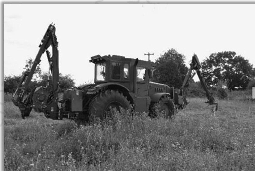
ตัวอย่างรูปภาพ รถกวาดทุ่นระเบิด 100-350 Mk2 ของบริษัท Armtrac (ที่มาของภาพ: Armtrac Ltd)
