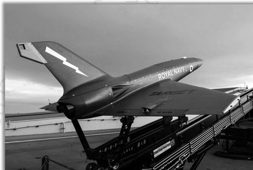
รูปภาพ การส่งเป้าบิน QinetiQ Banshee Jet 80+ บนเรือ HMS Prince of Trail (ที่มาของภาพ : Crown Copyright/Jane's)
