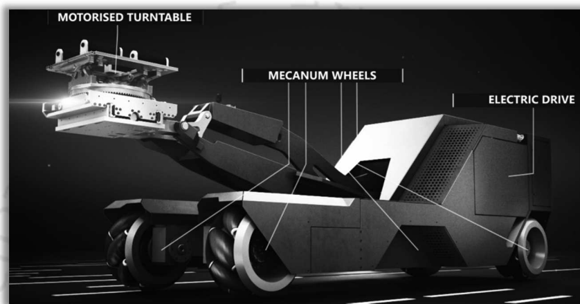
รูปภาพแบบจำลองระบบบรรจุอาวุธรอบทิศทาง (OWL) (ที่มาของภาพ : HOPE Technik)
