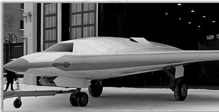
รูปภาพ อากาศยานไร้คนขับโจมตีขนาดหนัก Sukhoi S-70 Okhotnik (ที่มาของภาพ : RZOnline.RU)
