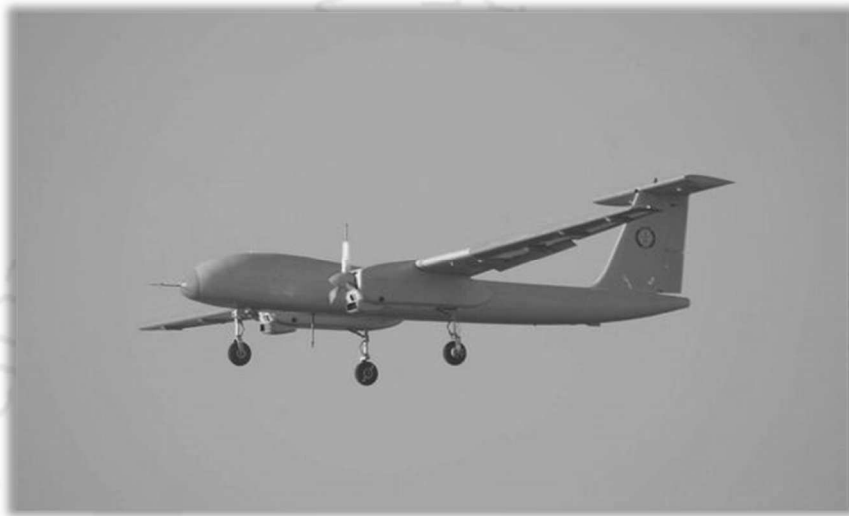
รูปภาพ อากาศยานไร้คนขับ Rustom II (ที่มาของภาพ : DRDO)
