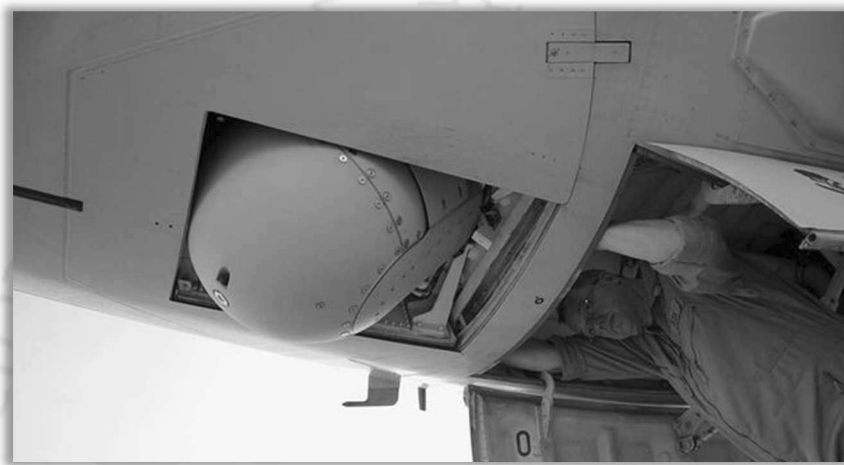
รูปภาพ ระบบกล้อง L3 WESCAM MX-20 EO/IR (ที่มาของภาพ : Bundeswehr)
