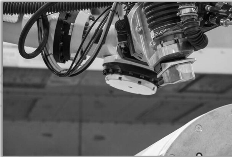
รูปภาพ เครื่องมือตรวจสอบความหนาของสารเคลือบผิว (ที่มาของภาพ : Aerobotix)
