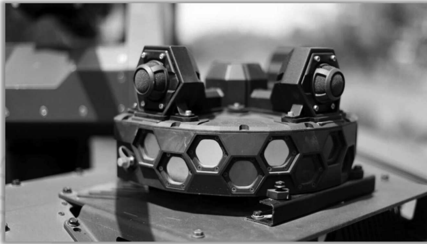
รูปภาพ ระบบตรวจจับการยิง OTHELLO-P ELO-5220P Optical & Acoustic Gunfire Detection System ของบริษัท L3Harris สหรัฐอเมริกา (ที่มาของภาพ : The Defense Post)
