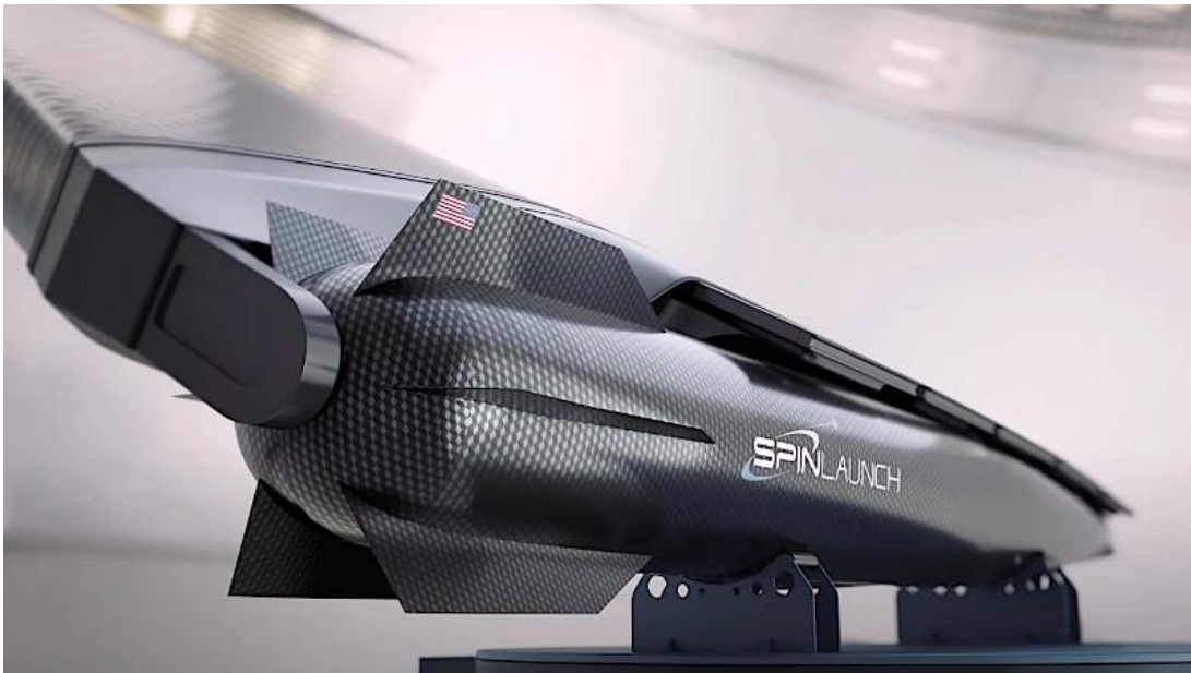
รูปที่ 2 แบบจำลองกระสวย SpinLaunch ที่ติดตั้งที่ปลายแกนหมุนเหวี่ยง
