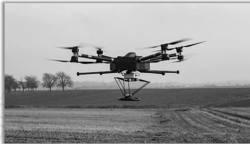
ตัวอย่างรูปภาพ อากาศยานไร้คนขับติดตั้งอุปกรณ์ตรวจจับทุ่นระเบิด (ที่มาของภาพ : Mine Kafor)
