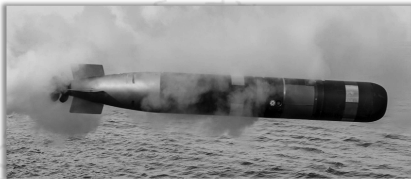
ตัวอย่างรูปภาพ ตอร์ปิโดแบบ Lightweight รุ่น MK 54 (Raytheon)
