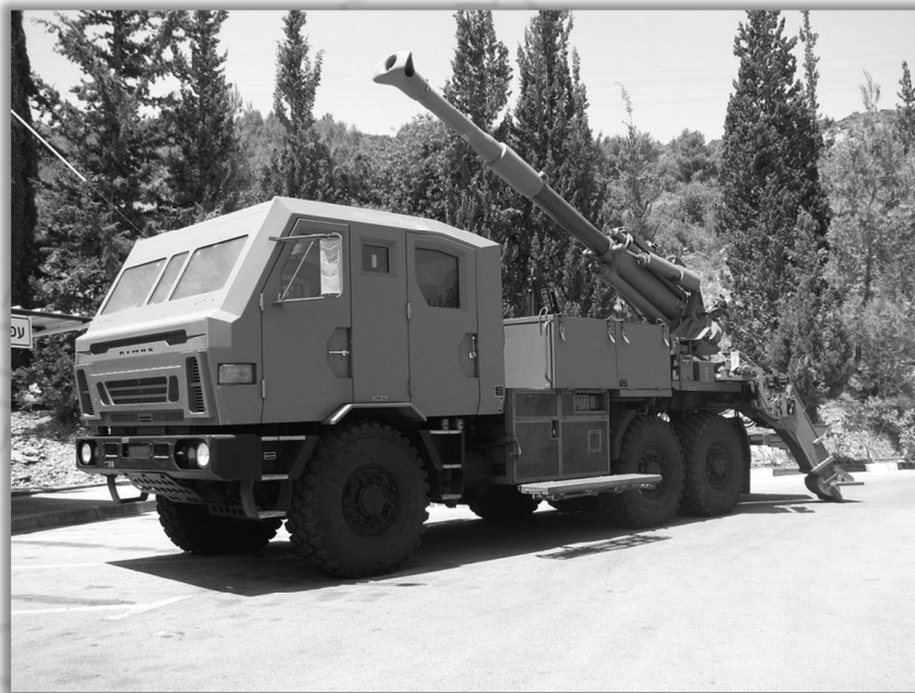
ตัวอย่างรูปภาพ ระบบปืนใหญ่อัตตาจร Soltam ATMOS Howitzer ขนาด 155 มม. (Wikipedia)
