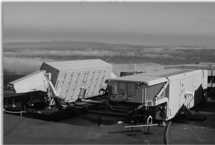
ตัวอย่างรูปภาพ เรดาร์แบบ AN/TPY-2 (U.S. Army)
