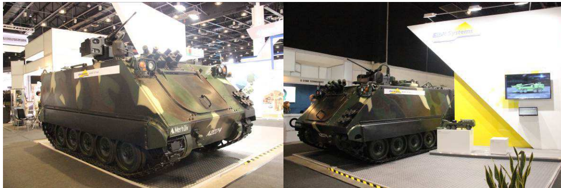
ยานเกราะสายพาน M113 ติดตั้งระบบอาวุธควบคุมระยะไกล RCWS ขนาด 12.7 มม.
