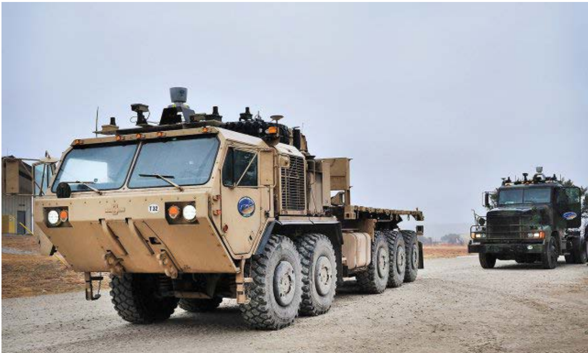
รถบรรทุกแบบ M1075 ที่ถูกดัดแปลงให้ทำงานโดยไม่มีคนขับ
