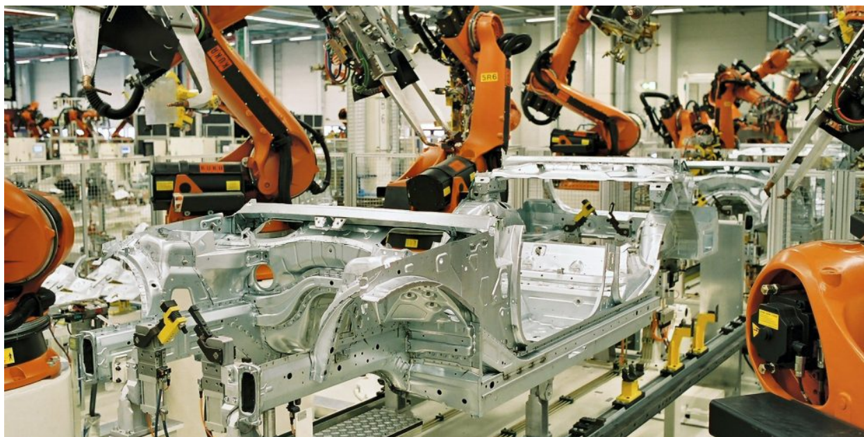
รูปที่ 2 การใช้หุ่นยนต์ในระบบสายพานการผลิตอัตโนมัติของ BMW
