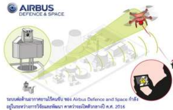
คำอธิบายภาพ ระบบต่อต้านอากาศยานไร้คนขับ ของบริษัท Airbus Defence & Space ที่ใช้ระบบ Sensor Data Fusion ในการประเมินภัยคุกคาม
