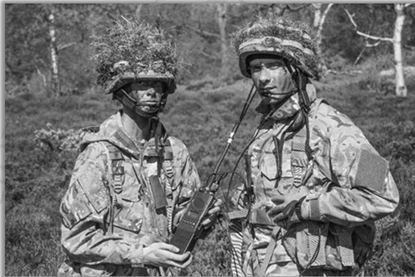
ตัวอย่างรูปภาพ โครงการ MERCURY PRC 710 Handheld VHF Radio (ที่มาของภาพ: Jane's)
