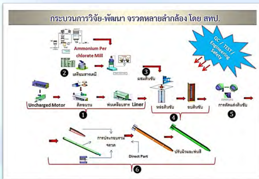
รูปที่ 22 กระบวนการผลิตจรวดหลายลำกล้องขนาด 122 มม. ที่วิจัยและพัฒนาโดย สทป.
