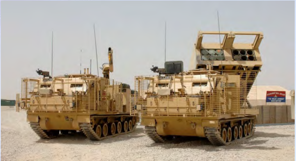
รูปที่ 17 รถยิง (Launcher Vehicle) และรถบรรจุจรวด (Loader Vehicle) ของระบบจรวดหลายลำกล้อง M270 ของสหรัฐอเมริกา ซึ่งใช้ยานรบ (Platform) แบบเดียวกัน
