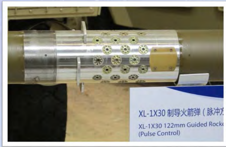
รูปที่ 13 จรวดหลายลำกล้องนำวิถีด้วยระบบ Pulse Control ของจีน
