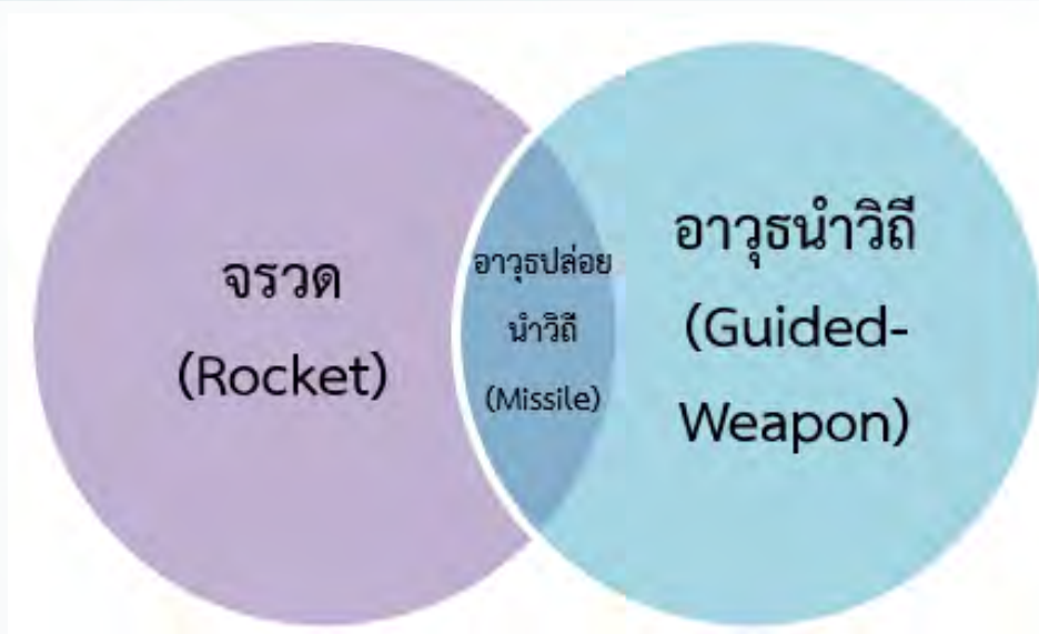
รูปที่ 2 แผนภาพแสดงความสัมพันธ์ระหว่างจรวด อาวุธนำวิถี และอาวุธปล่อยนำวิถี
