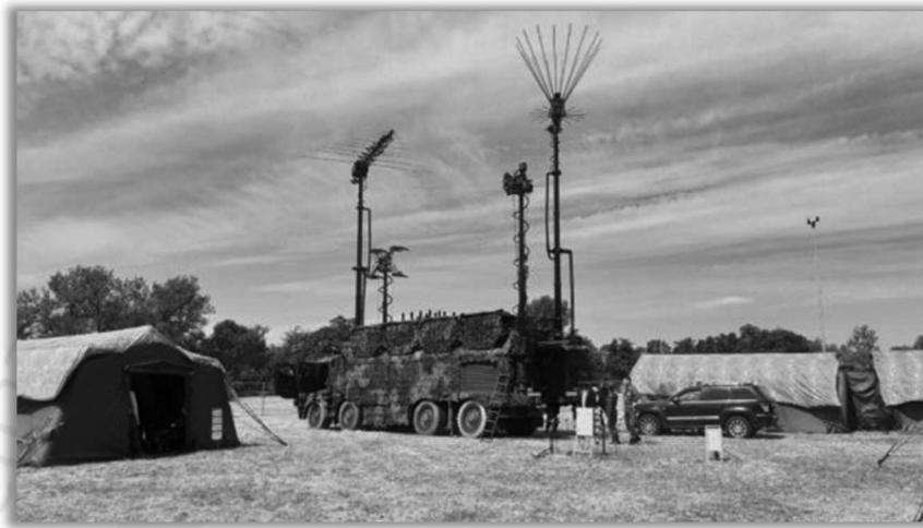
รูปภาพ เครื่องรบกวนสัญญาณ STARKOM (ที่มาของภาพ : URC Systems)
