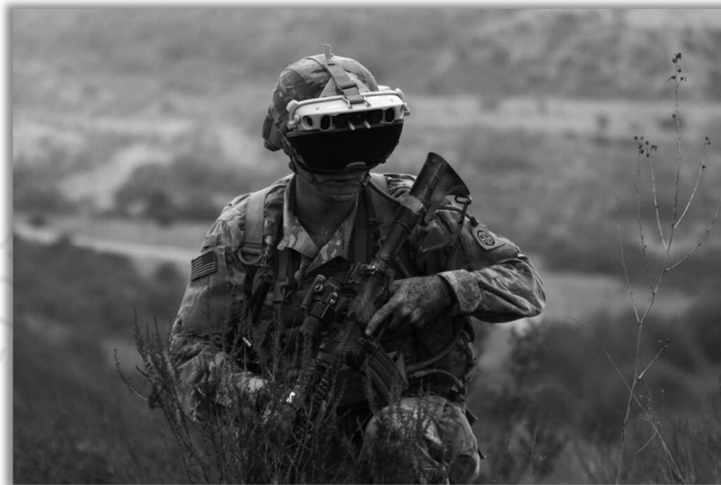
รูปภาพ อุปกรณ์แว่นตาเทคโนโลยีความเป็นจริงแบบผสมทางยุทธวิธีของสหรัฐอเมริกา (ที่มาของภาพ : The Defense Post)
